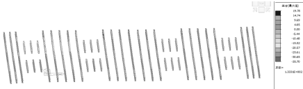
图6 纵向分配梁的正应力
