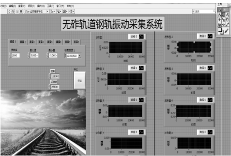
图 2 LabVIEW 钢轨振动采集系统界面前面板
